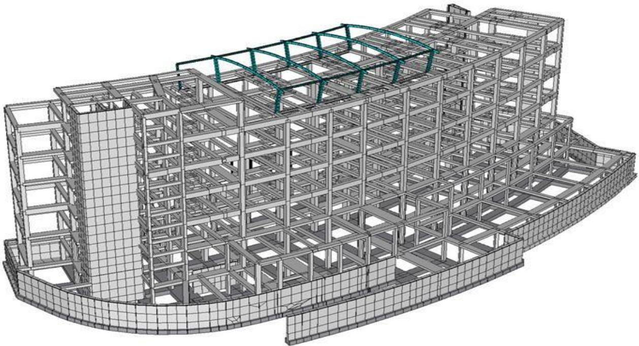
Il Progetto 3D ripropone fedelmente lo stato finale e costituisce un eccezionale strumento di verifica della progettazione per tutta la durata delle opere.
